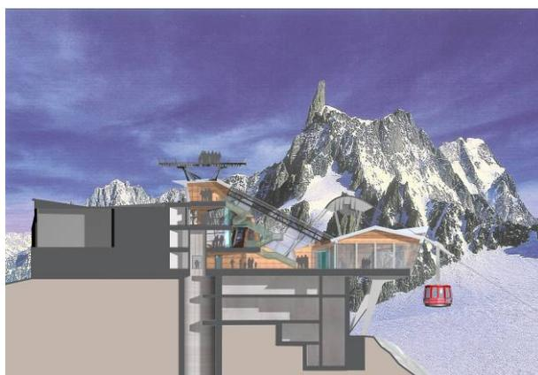
stazione di monte – sezione modello con pozzo
